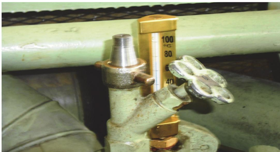
Рис. 2. Общий вид устройства для отбора частиц сажи из камеры сгорания судового дизеля 6ЧН 24/36
