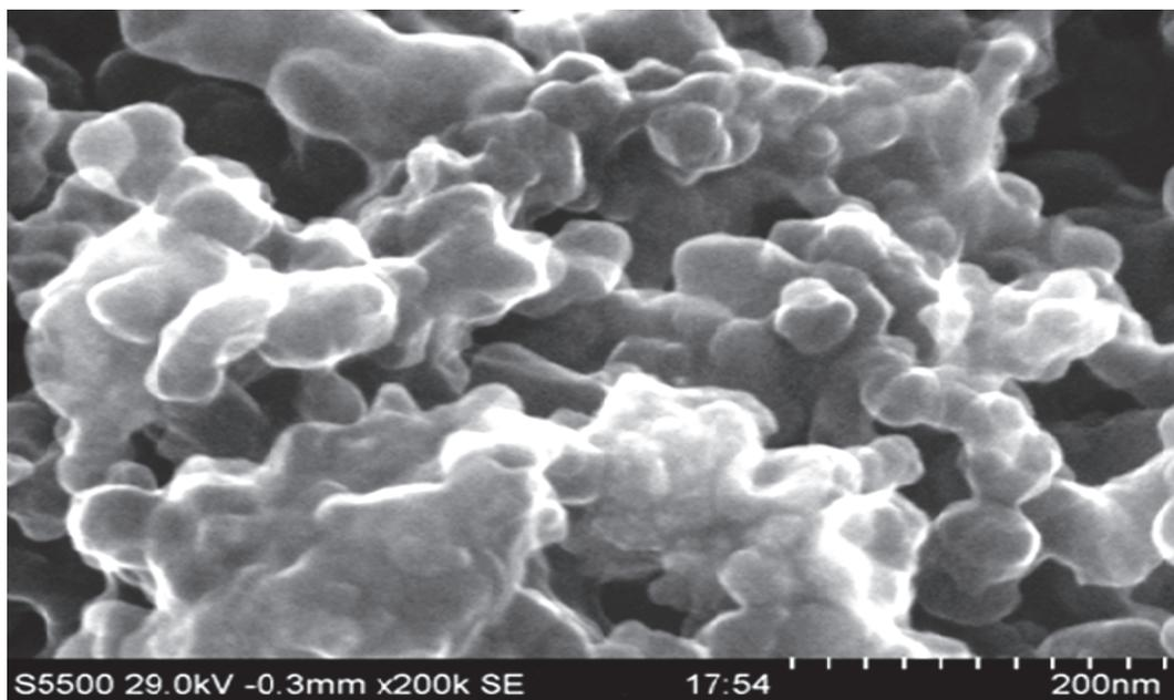
Рис. 6. Электронно-микроскопический снимок частиц сажи судового дизеля 6ЧН 24/36 при нагрузке 25 % от  $Ne_{\text{ном}}$ , увеличение 200 тыс. раз
